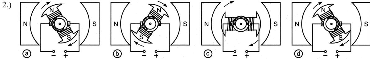
Warum beginnt sich der Motor in Bild a zu drehen, wenn der Strom eingeschaltet wird?
