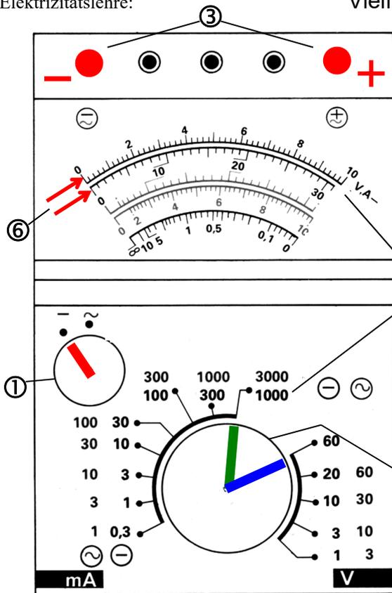
Mit dem Polytest kann man die **Stromstärke I** **oder** die **Spannung U** messen.
