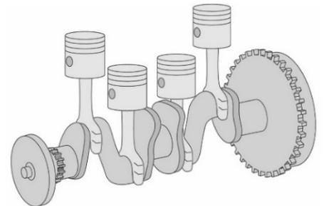
Jeder der 4 Kolben bewegt sich in einem eigenen **Zylinder auf** und **ab**.
