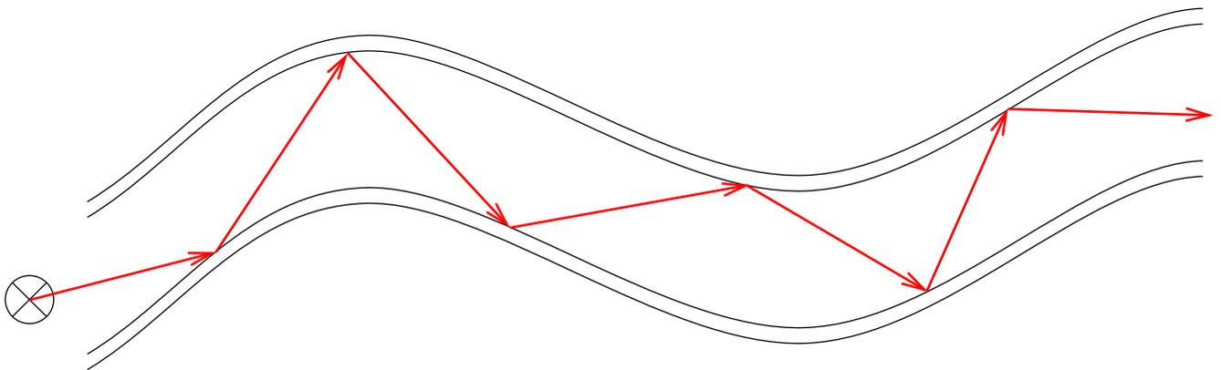
Mit Hilfe einer Lichtquelle wird Licht in den Lichtleiter gesendet. Normalerweise würde das Licht beim ersten Auftreffen auf die Wand des Lichtleiters das Glasfaserkabel **verlassen**.
