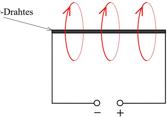
Die Magnetkraft **eines** stromdurchflossenen **Leiters** lässt sich **verbessern**, wenn man ihn in vielen **Windungen** zu einer **Spule** aufwickelt.
