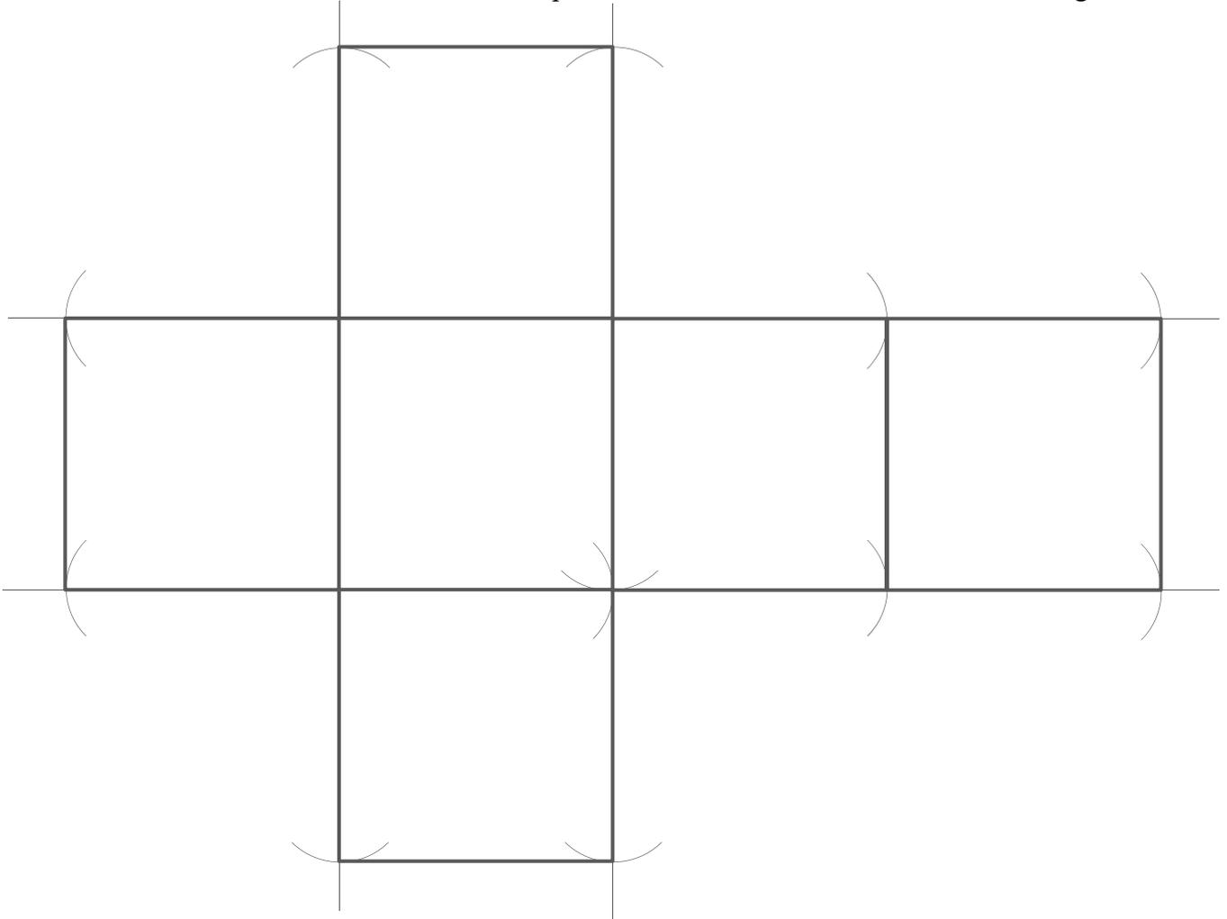
Zeichne mit **Geo-Dreieck & Zirkel** das Körper-Netz eines **Würfels** mit einer **Kantenlänge** von **3,5 cm!**
